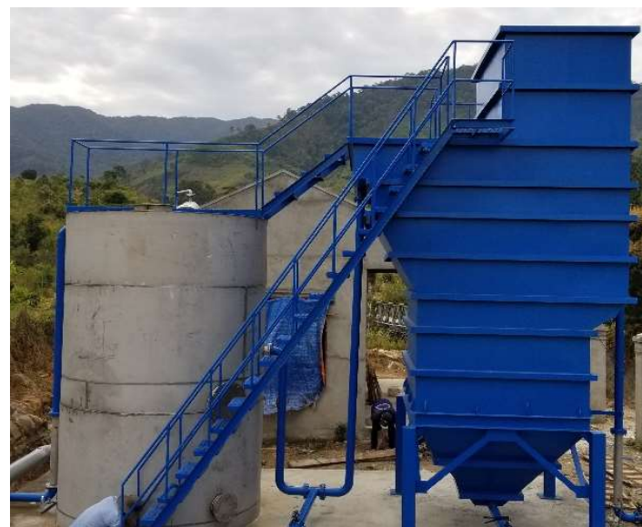
Hệ Lamella - Xiphong 30m 3 /h (Trạm CN Đam Rông - Lâm Đồng)
